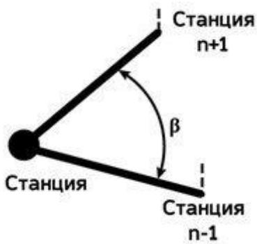
Измерение горизонтального угла на станции n:
