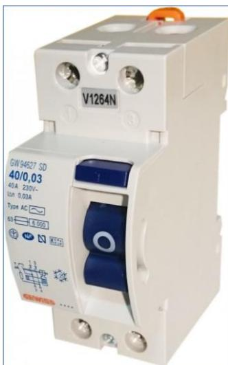
В основе их конструкции лежит дифференциальный трансформатор. Он состоит из ферритового кольца и одной обмотки на нем, которая и играет роль индикатора дисбаланса. В однофазной бытовой сети через ферритовое кольцо пропущены фазный проводник и нейтраль. Направления токов в них противоположны и уравновешивают друг друга, поэтому во вторичной обмотке ток не течет.
