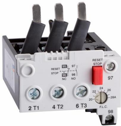
Электрическая перегрузка может быть вызвана излишним физическим сопротивлением работе электродвигателя. Для ее предотвращения используются термореле. Это устройство состоит из отрезка нихромовой проволоки, играющей роль нагревательного элемента, и биметаллического размыкателя, вокруг которого она обвита.
