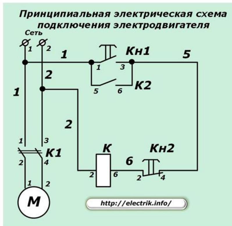
Мощные силовые нормально разомкнутые контакты контактора 1-2 и 3-4 позволяют управлять работой электродвигателя М, а 5-6 применяется для создания цепи самоудержания обмотки А-Б под напряжением после нажатия и отпущения кнопки Кн1 «Пуск» с замыкающим контактом 1-3.
